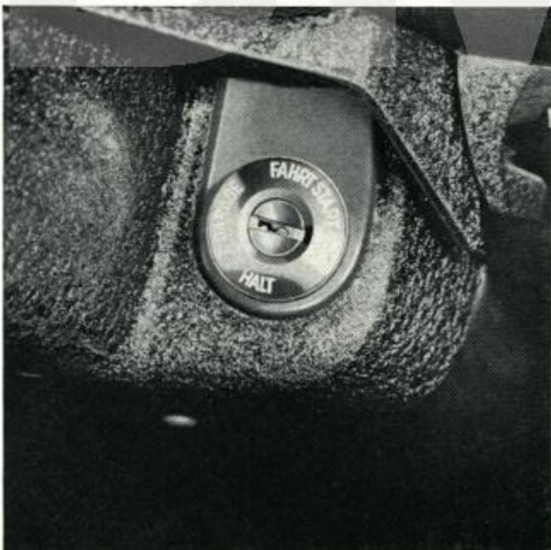
und Öldruck-Kontrolleuchte (orange) brennen, Kraftstoffanzeige ist in Betrieb; Zündschlüssel kann nicht abgezogen werden.
