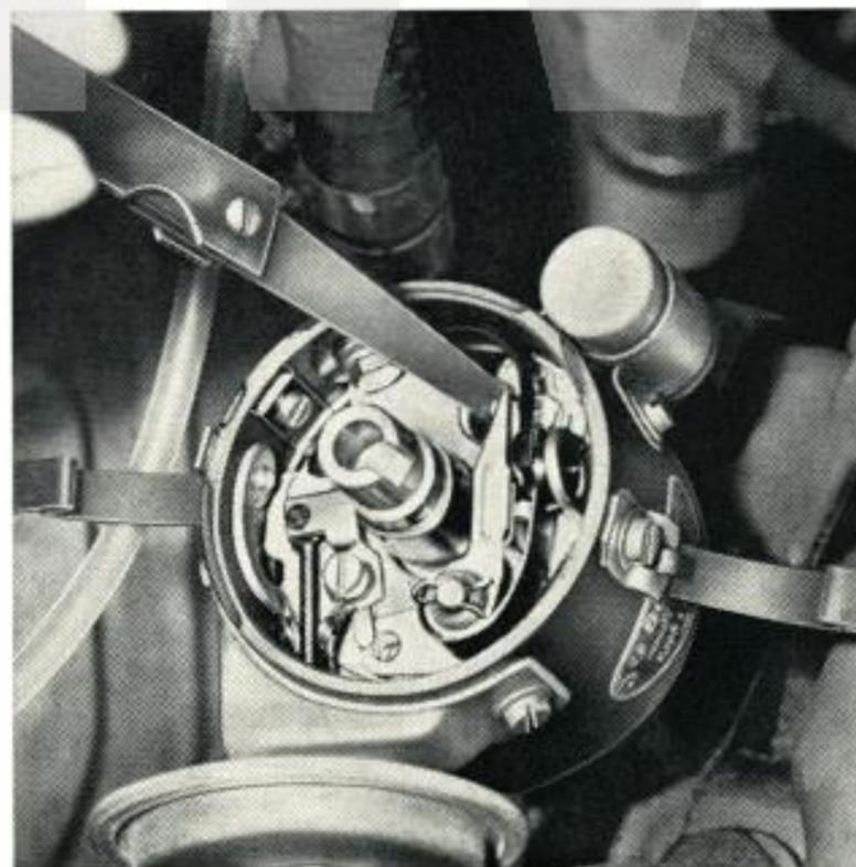
brannte Kontakte mit Kontaktfeile glätten, stärker verbrannte Kontakte erneuern. Kontaktabstand 0,4 mm mit Fühlerblattlehre prüfen. **Bild 81**
