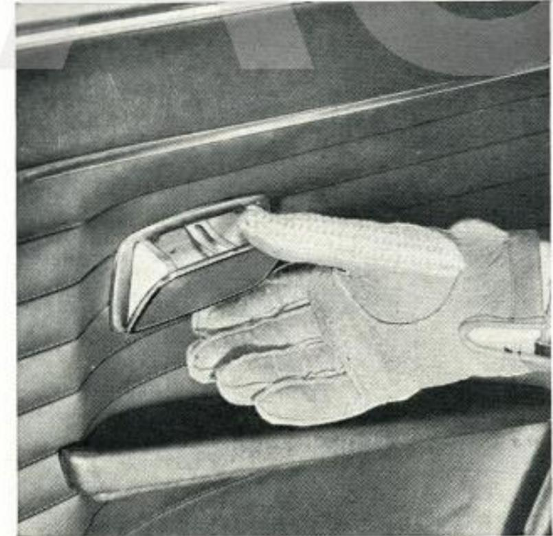
Zur **Vordersitzverstellung** in Längsrichtung ziehen Sie den Hebel (**Bild 28, 1**) an der Sitzaußenseite nach oben und verschieben den Sitz in die gewünschte Stellung, dann Hebel loslassen und auf richtiges Einrasten der Arretierung achten.
