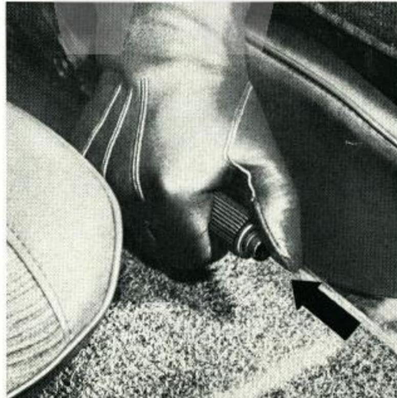
Die Stellung des Schalthebels in den einzelnen Gängen ersehen Sie aus dem **Schaltschema**. Sämtliche Vorwärtsgänge sind sperrsynchronisiert. **Bild 24**
