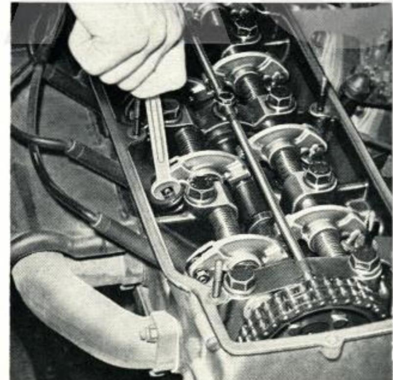
Exzenter mit einem leicht angewinkelten Draht (2,5 mm  $\phi$ ) verdrehen, bis das vorgeschriebene Spiel erreicht ist. **Bild 89** Sechskantmutter festziehen und Ventilspiel nochmals kontrollieren.
