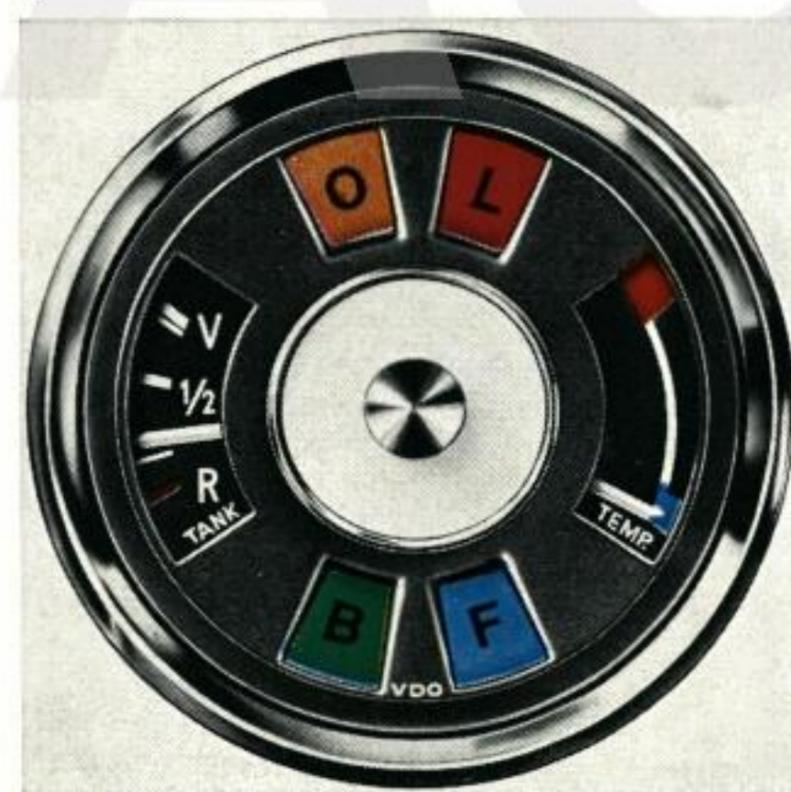
Am **Kraftstoffanzeiger** kann bei eingeschalteter Zündung der Kraftstoffstand abgelesen werden. Steht der Zeiger auf »**Reserve**«, dann sollten Sie tanken, obwohl noch für etwa 50 km (je nach Fahrweise) Kraftstoff im Behälter ist.
